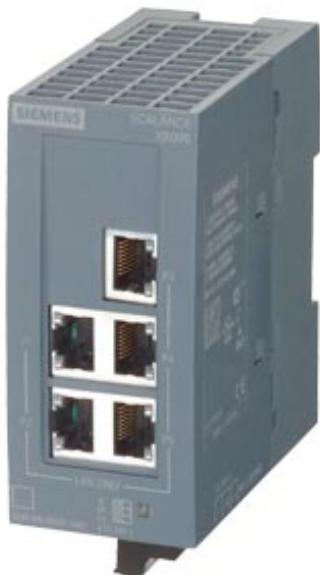
SCALANCE XB005 unmanaged Industrial Ethernet Switch für 10/100 Mbit/s; zum Aufbau von kleinen Stern- und Linienstrukturen; LED-Diagnose, IP20, AC/DC 24V Spannungsversorgung, mit 5x 10/100 Mbit/s Twisted Pair Ports mit RJ45-Buchsen; Handbuch als Download verfügbar
