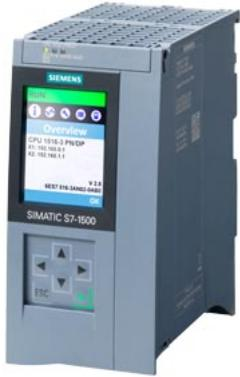
\*\*\* Ersatzteil \*\*\* SIMATIC S7-1500, CPU 1516-3 PN/DP, Zentralbaugruppe mit Arbeitsspeicher 1MByte für Programm und 5MByte für Daten, 1. Schnittstelle: PROFINET IRT mit 2 Port Switch, 2. Schnittstelle: PROFINET RT, 3. Schnittstelle: PROFIBUS, 10 ns Bit-Performance, SIMATIC Memory Card notwendig
