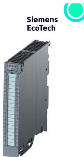
SIMATIC S7-1500, Digitalausgabemodul DQ 32xDC 24V/0,5A HF; 32 Kanäle in Gruppen zu 8; 4A pro Gruppe; Einzelkanaldiagnose; Ersatzwert, Schaltspielzähler für angeschlossene Aktoren. Baugruppe unterstützt das sicherheitsgerichtete Abschalten von Lastgruppen bis zu SIL2 gemäß EN IEC 62061:2021 und Category 3 / PL d gemäß EN ISO 13849-1:2015. Frontstecker (Schraubklemmen oder Push-In) separat bestellen
