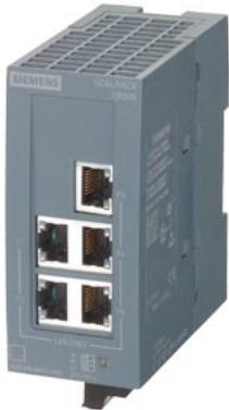
SCALANCE XB005 unmanaged Industrial Ethernet Switch für 10/100 Mbit/s; zum Aufbau von kleinen Stern- und Liniensstrukturen; LED-Diagnose, IP20, AC/DC 24V Spannungsversorgung, mit 5x 10/100 Mbit/s Twisted Pair Ports mit RJ45-Buchsen; Handbuch als Download verfügbar.
